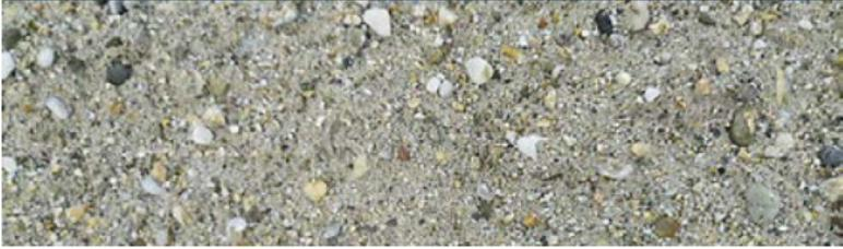
**Colmix® predstavlja specijalnu mješavinu šljunčanih agregata namijenjenu za proizvodnju betonske smjese, specijalno dizajniranu prema zahtjevima naših kupaca.**
