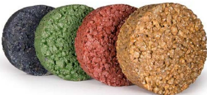
**Colclair®** je naziv za asortiman asfalta u boji kod kojeg se umjesto klasičnog cestograđevnog bitumena koristi sintetičko vezivo **Bituclair®**.
